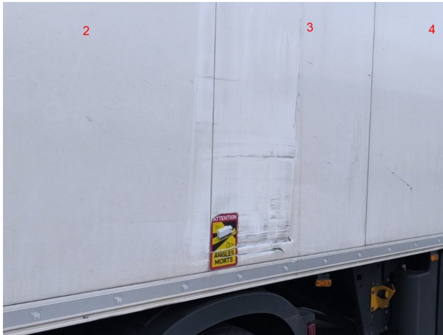
Seitenwand links im vorderen Bereich unfallbedingt beschädigt; Segment Nr. 3 im unteren Bereich verformt und eingerissen, Segment Nr. 2 verkratzt
