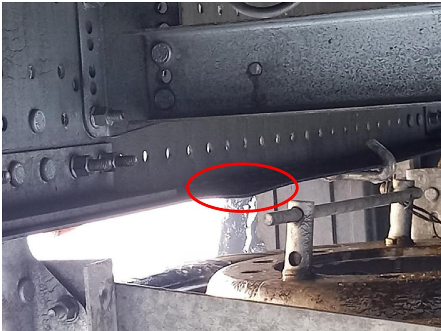
Rahmenlängsträger auf der linken Seite unfallbedingt verformt
