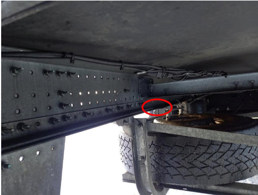
Rahmenlängsträger auf der linken Seite unfallbedingt verformt
