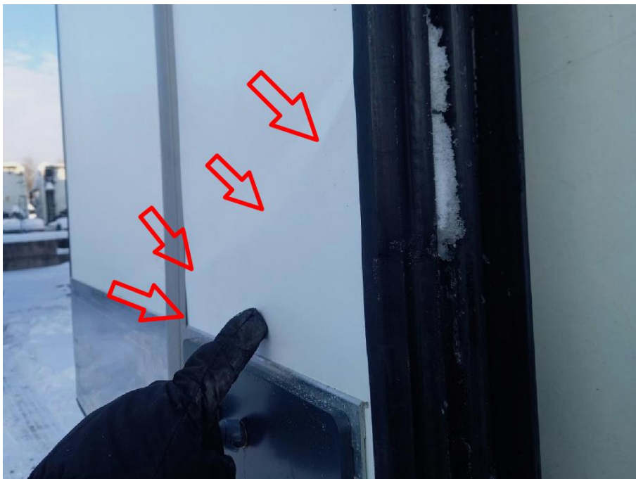
Rückwandtür rechts innen im unteren Bereich gestaucht und verformt
