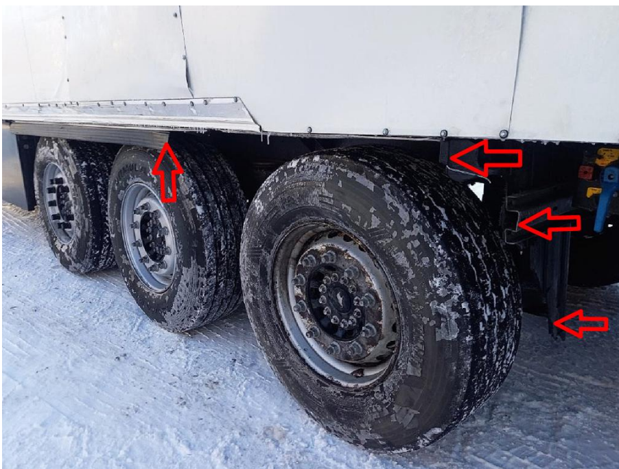
Kotflügel/Schmutzfänger an der 3. Achse links gebrochen, Halter deformiert. Antisprayschürze gerissen
