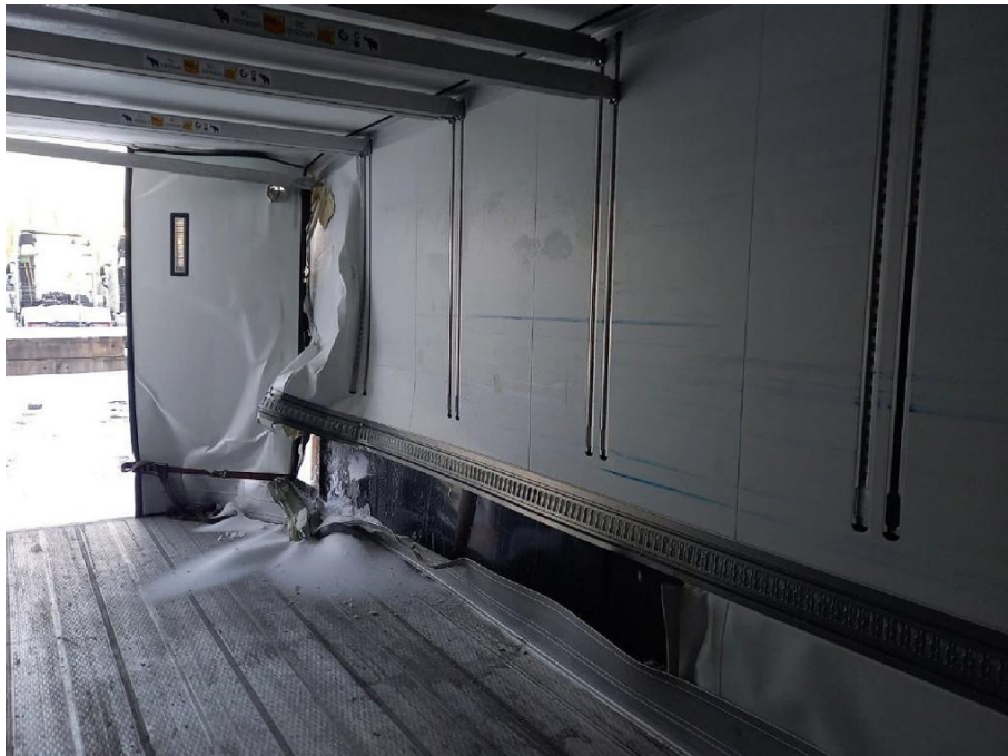
Beschädigungen der linken Seitenwand (Innenansicht)
