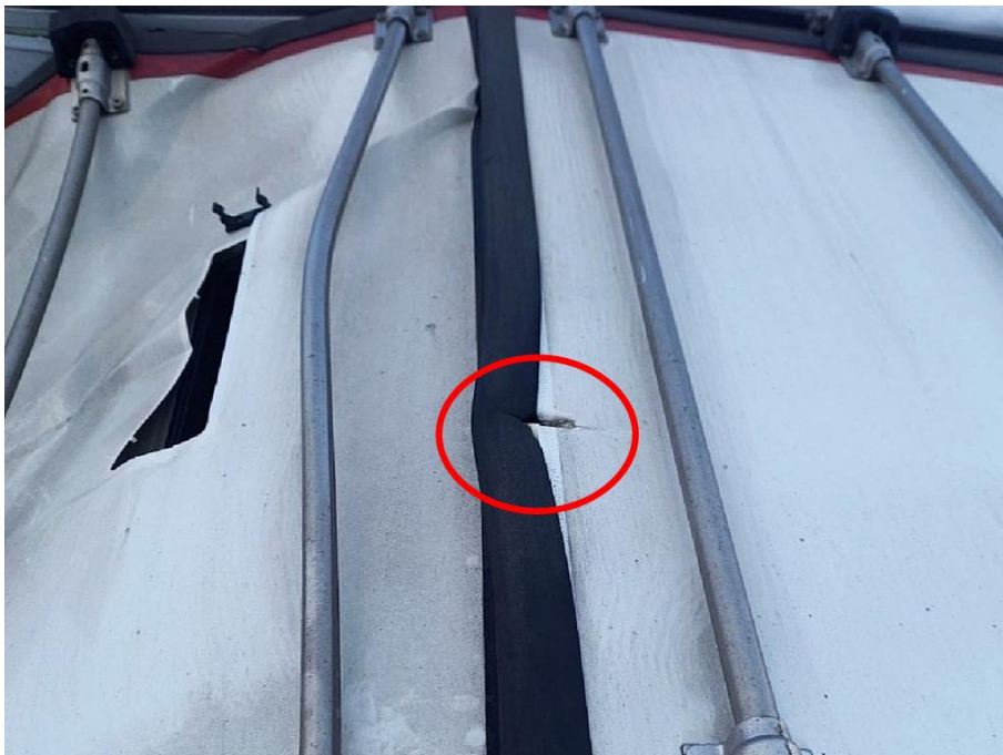
Rückwandtür links stark deformiert, Rückwandtür rechts gerissen
