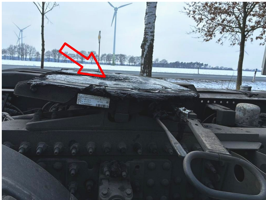
Anstoßbereich: Unfallbedingt beaufschlagte Aufsattelkupplung
