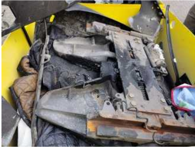
Träger Sattelplatte abgerissen (Archivbild, gleicher Schadenhergang)
