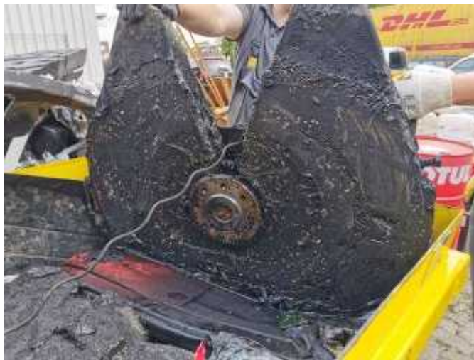
Sattelplatte abgerissen (Archivbild, gleicher Schadenhergang)
