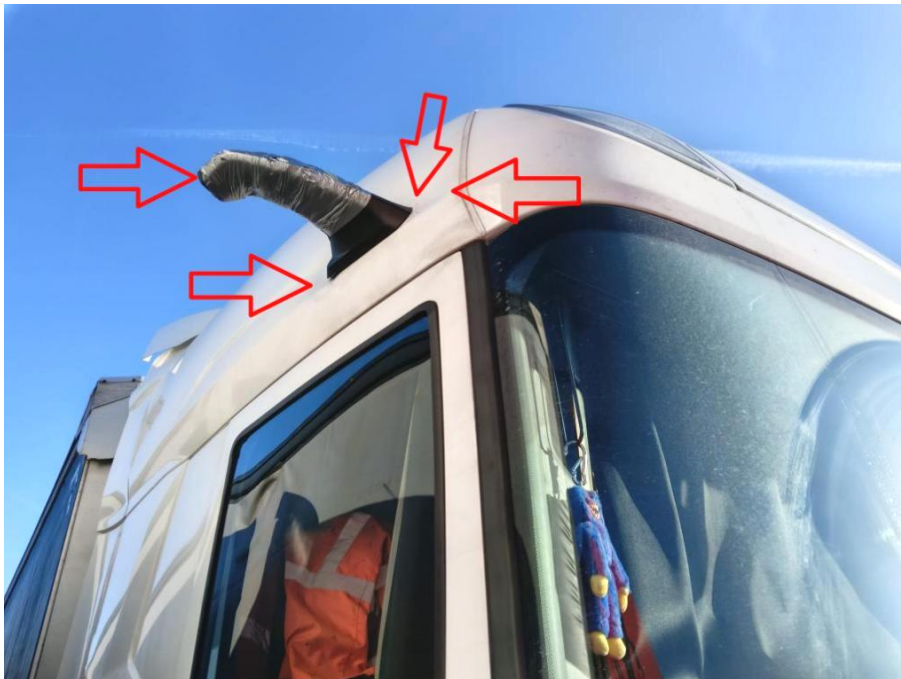
Fahrerhausdach vorn rechts deformiert/eingedrückt, Außenspiegelkamera rechts beansprucht/teilweise abgerissen (provisorisch mit Klebeband fixiert)
