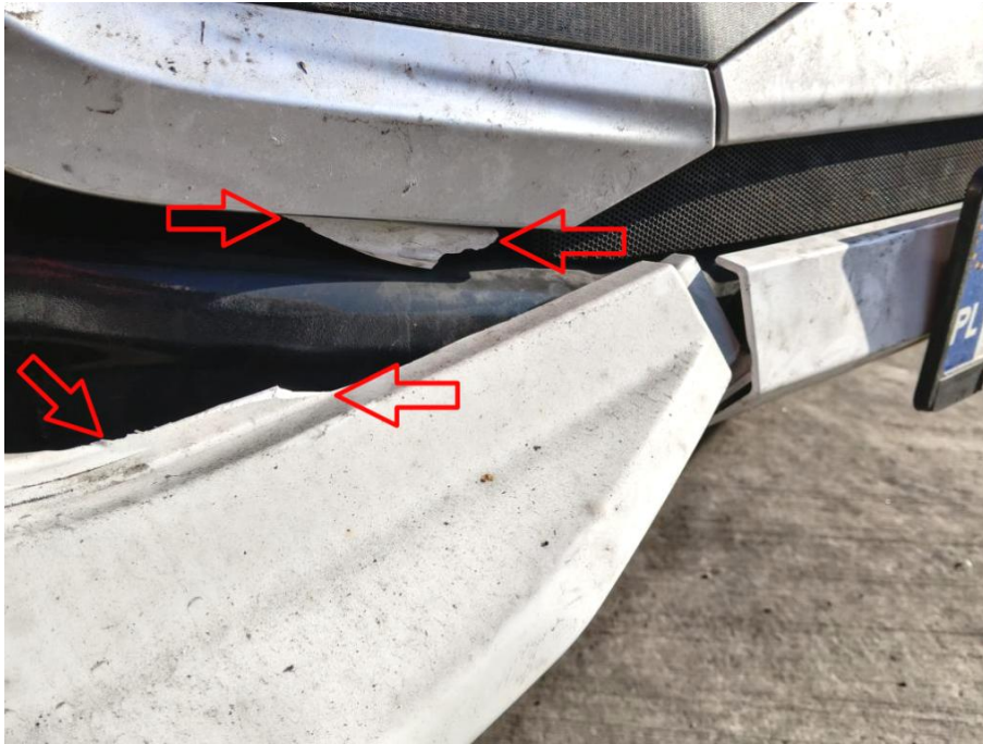
Stoßstangenverkleidung vorn rechts gebrochen/teilweise abgerissen
