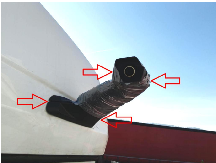
Außenspiegelkamera rechts beansprucht/teilweise abgerissen (provisorisch mit Klebeband fixiert)
