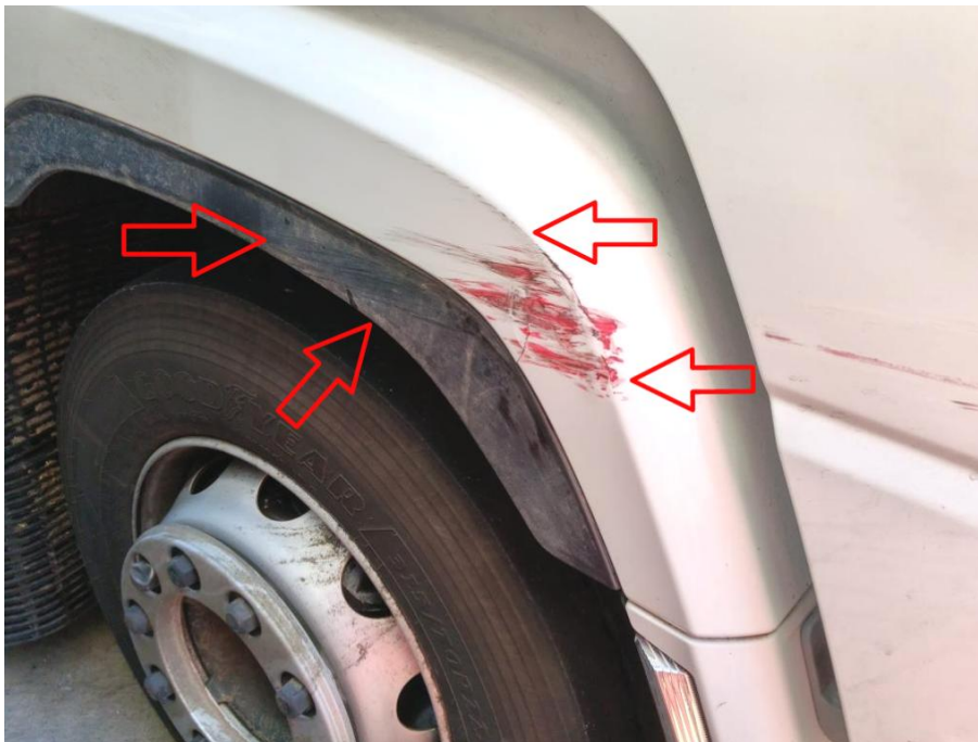
Radlaufverkleidung 1. Achse rechts eingedrückt/gebrochen, Radlaufverlängerung 1. Achse rechts verkratzt
