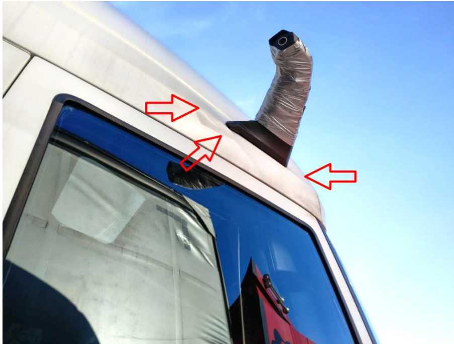
Fahrerhausdach vorn rechts deformiert/ingedrückt
