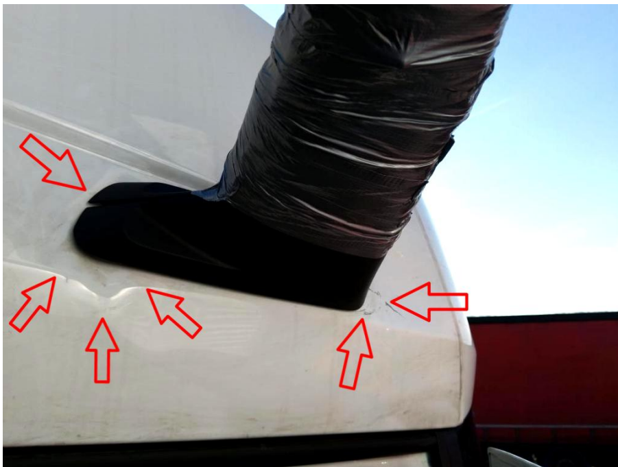
Fahrerhausdach vorn rechts deformiert/ingedrückt
