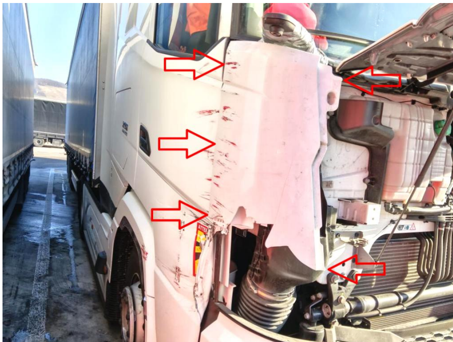
Fahrerhauswindabweiser vorn rechts gebrochen
