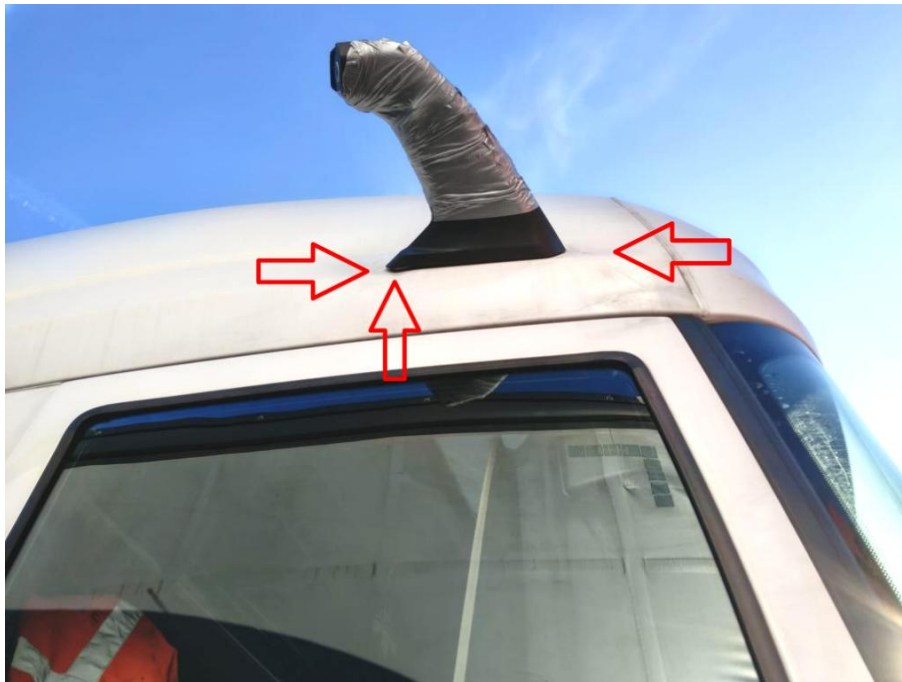
Fahrerhausdach vorn rechts deformiert/ingedrückt
