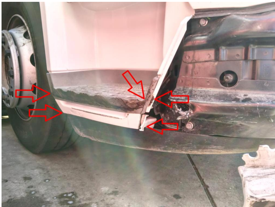
Einstieg unten rechts deformiert/ingedrückt/verschrammt/tiefe Kratzer, Trittstufe unten rechts gebrochen/verschrammt/tiefe Kratzer
