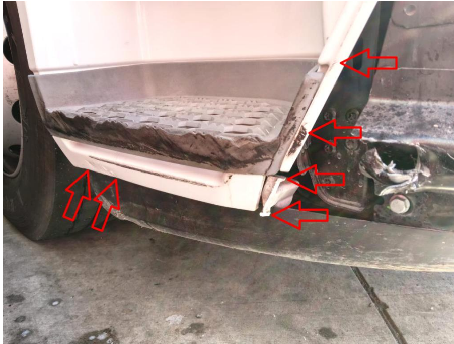
Einstieg unten rechts deformiert/ingedrückt/verschrammt/tiefe Kratzer, Abdeckleiste Einstieg unten rechts abgerissen
