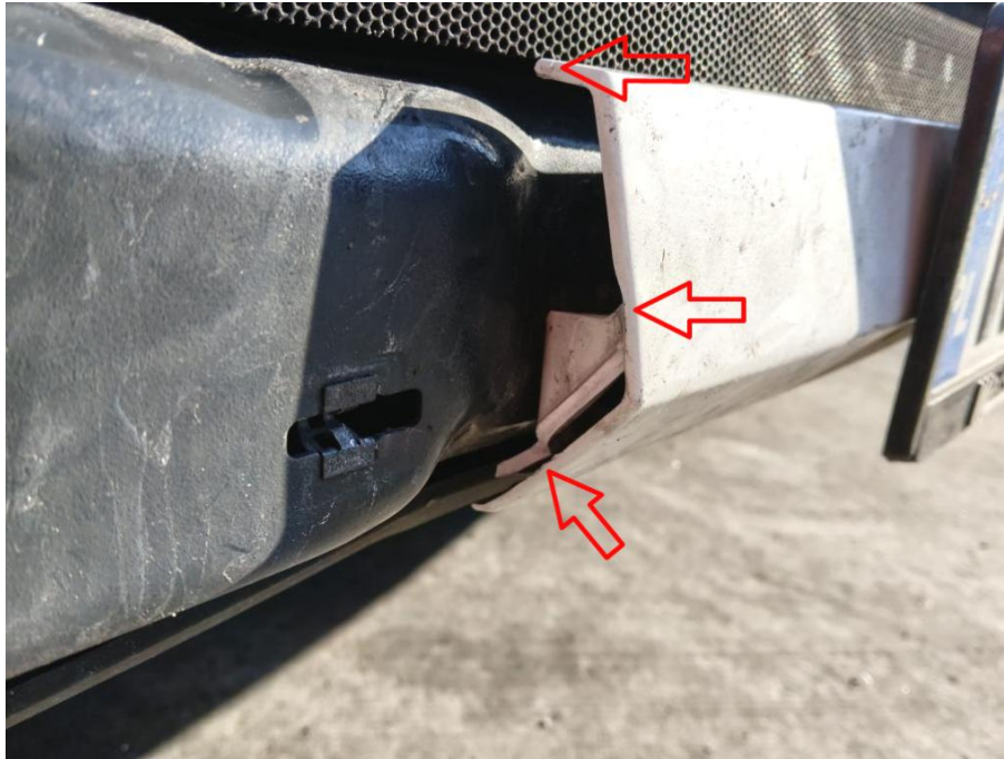
Stoßstangenverkleidung vorn Mitte verkratzt
