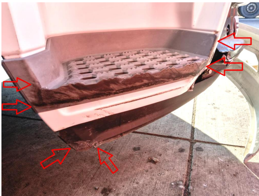
Trittstufe unten rechts verschrammt/tiefe Kratzer, Unterboden vorn rechts gebrochen/verkratzt
