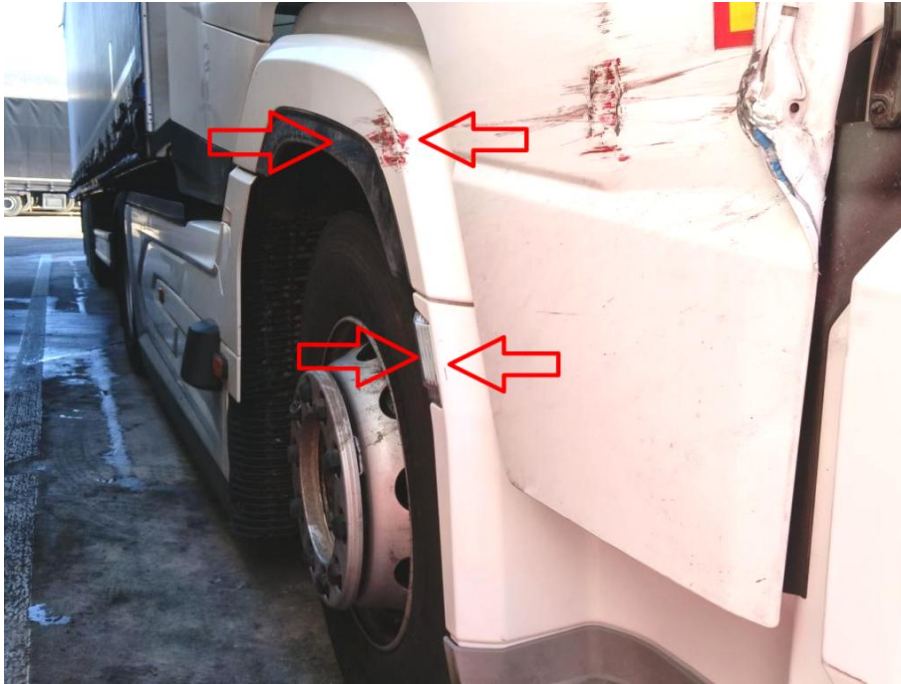
Radlaufverkleidung 1. Achse rechts eingedrückt/gebrochen, Blinkleuchte LED vorn rechts beansprucht/ingedrückt
