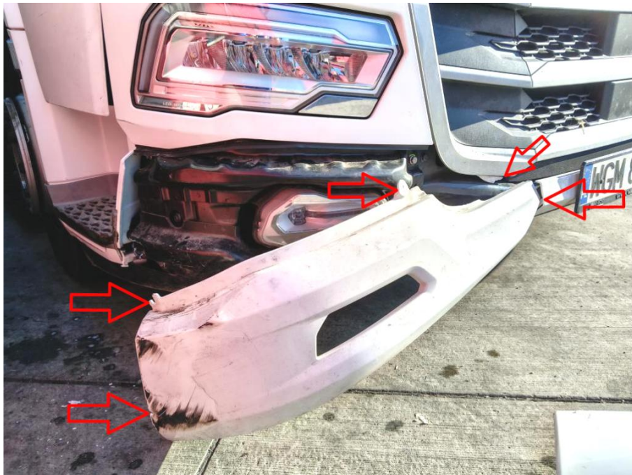
Stoßstangenverkleidung vorn rechts gebrochen/teilweise abgerissen, Stoßstange vorn rechts deformiert/ingedrückt
