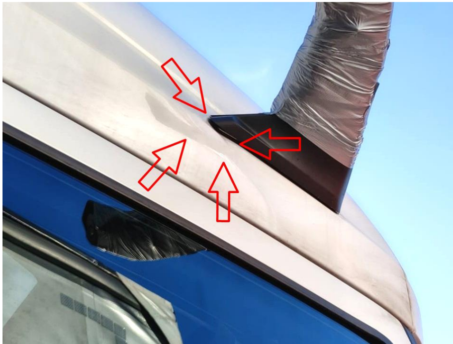
Fahrerhausdach vorn rechts deformiert/ingedrückt
